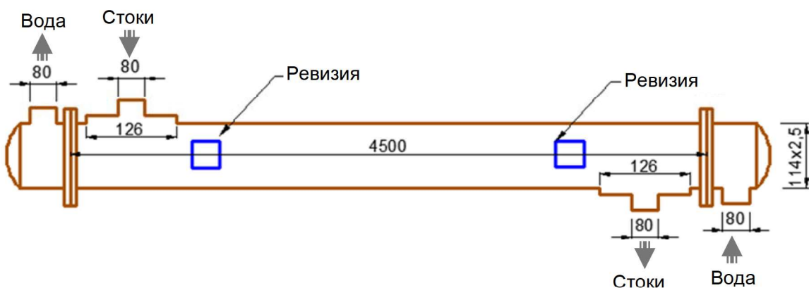
Рис. 2. Конструкция секции кожухотрубного теплообменника
