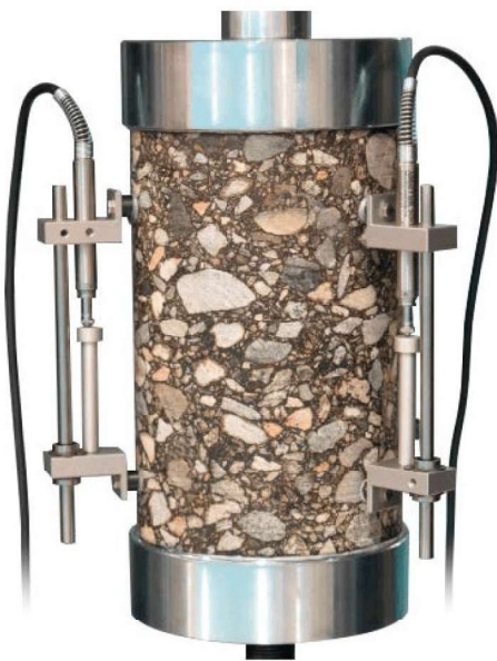
Рис. 2. Вырезаемый цилиндрический образец
