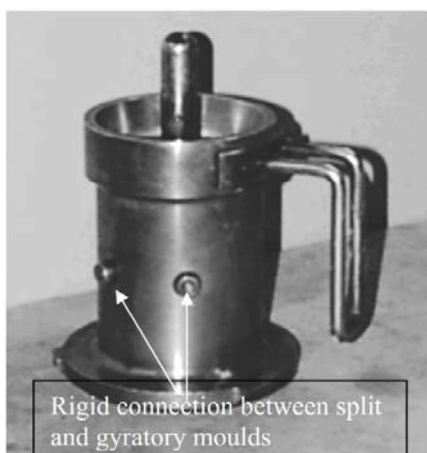
Рис. 3. Форма для параболического образца Эркенса-Пута
