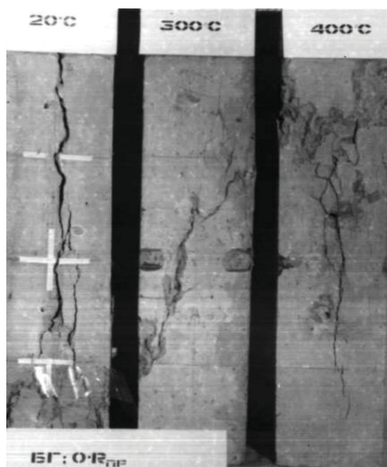
Рис. 2. Трещины в призмах бетона при 20 °C
