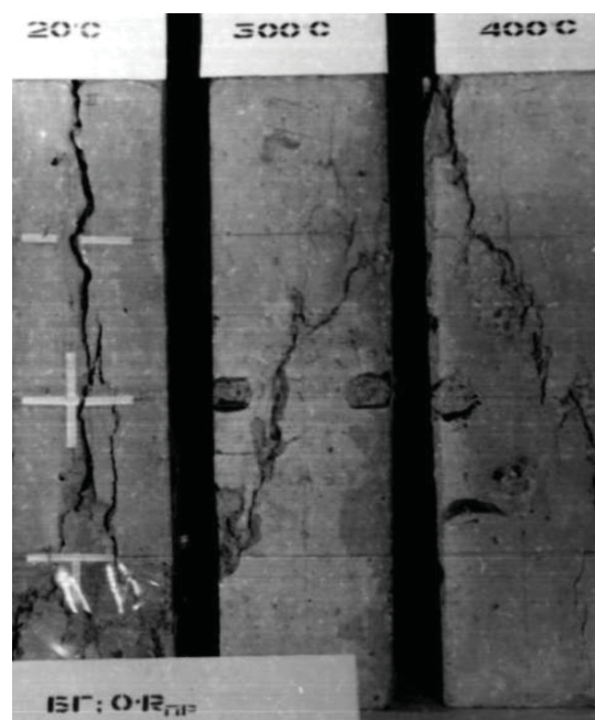
Рис. 3. Развитие трещин в ненагретых и нагретых без нагрузки (при \eta' = 0 ) призмах бетона
