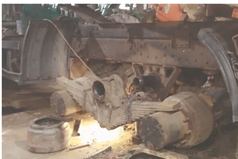
Рис. 4. Ремонт балансирующей подвески автомобиля КамАЗ
