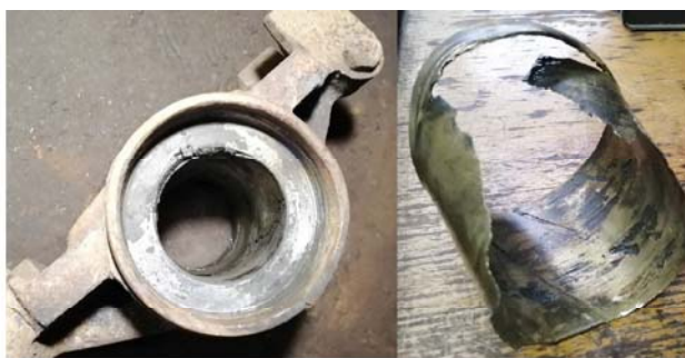
Рис. 6. Башмак балансира с разрушенным подшипником скольжения
