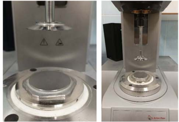
Рис. 7. Измерительная схема реометра Physica MCR 102, Anton Paar, тип «плоскость – плоскость»
