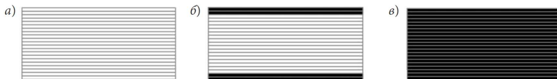
Рис. 1. Рассматриваемые варианты пластин для численного моделирования НДС: а — пластина из стеклопластика; б — гибридная пластина; в — пластина из углепластика
