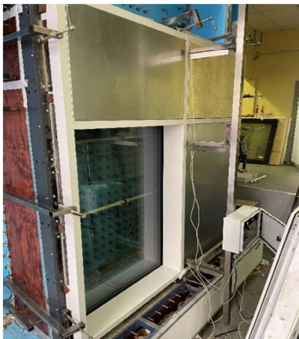
Рис. 1. Испытание модуля КФС на воздухопроницаемость на стенде СПбГАСУ
