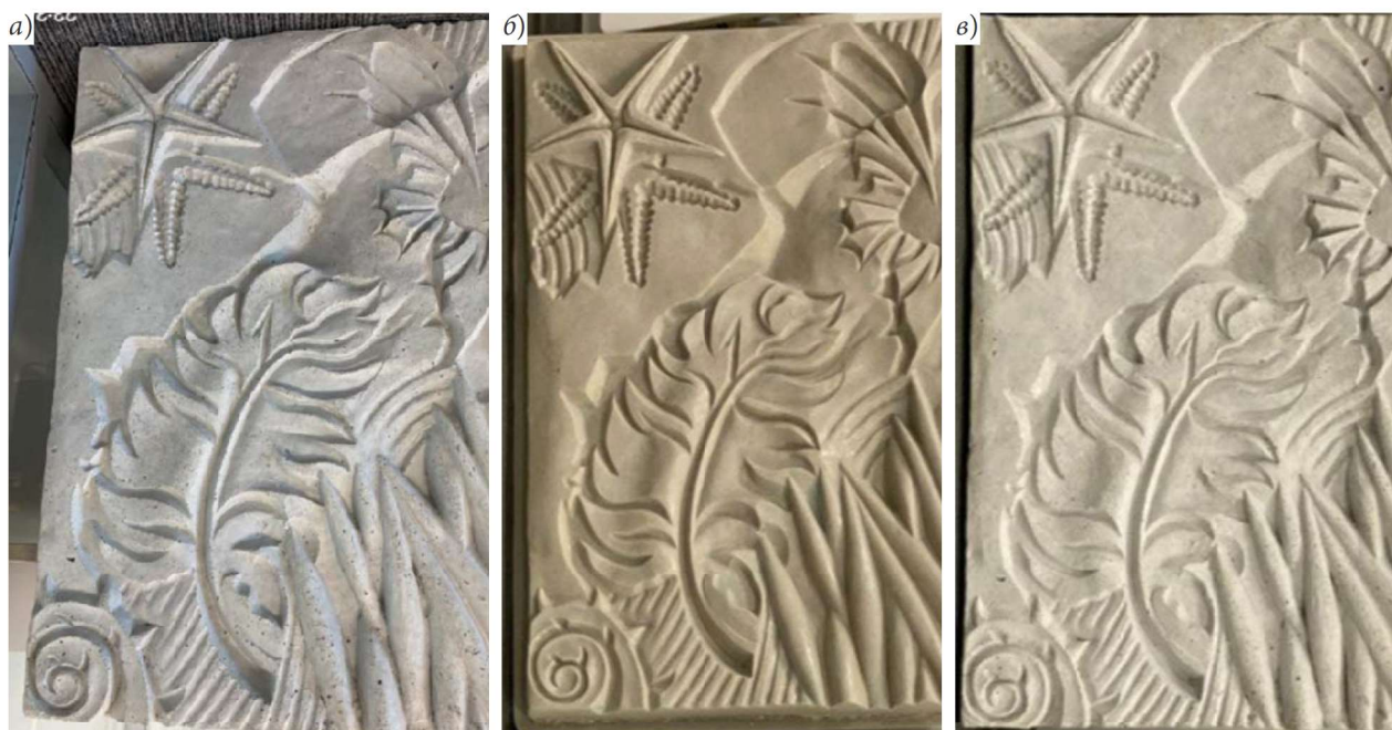
Рис. 5. Образцы барельефов: а — стеклофибробетон; б — полимербетон; в — стеклопластик
