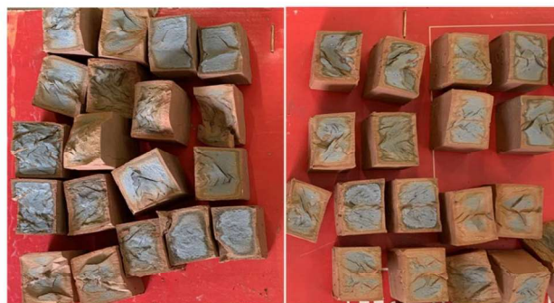
Рис. 3. Обломки образцов после испытания на изгиб (справа образцы с ультразвуковой формовкой)
