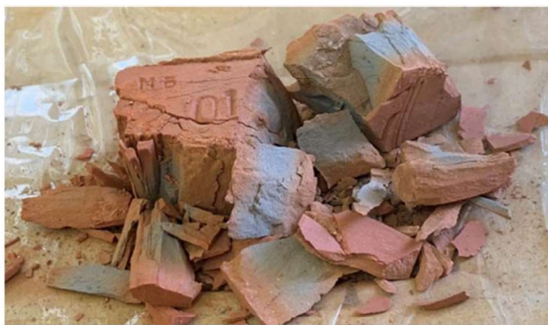
Рис. 2. Образец после разрушения сжатием
