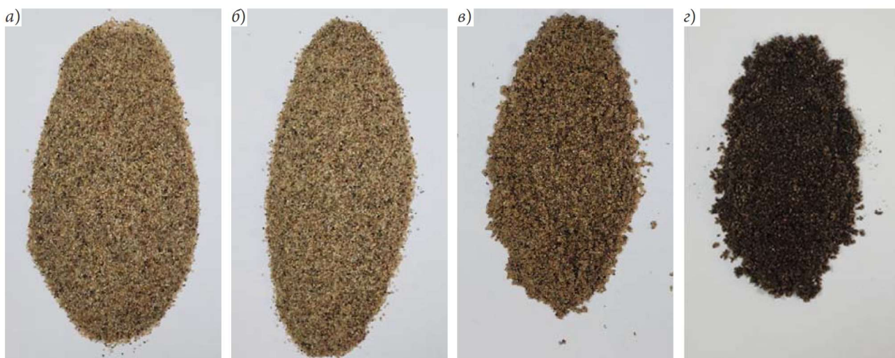
Рис. 3. Песок крупный монофракционный, а — чистый, б — загрязненный бензином А-95, в — загрязненный дизельным топливом, з — загрязненный тяжелой нефтью
