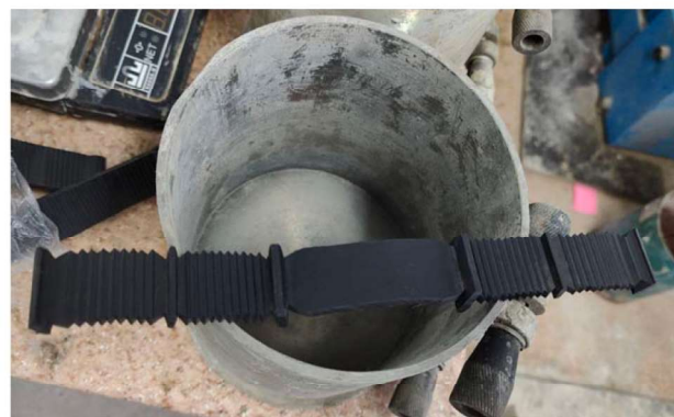
Рис. 4. Закладная деталь, выполненная из ПВХ гидрошпонки ХВ 320 с восстановленной торцевой поверхностью
