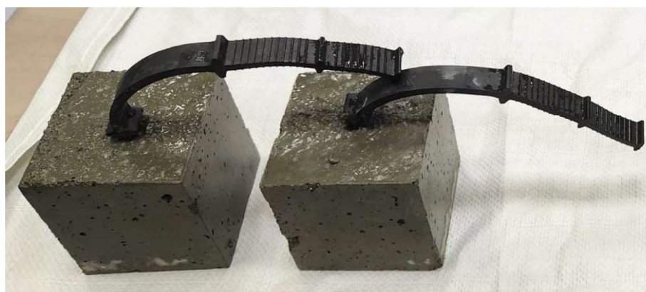
Рис. 5. Бетонные образцы 100 \times 100 \times 100 мм с установленной закладной деталью из ПВХ гидрошпонки ХВ 240
