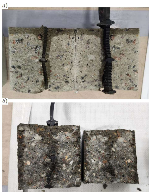
Рис. 6. Расколотые образцы: а — из бетона (первая серия); б — из смеси «Алит СМБ-1ср» (вторая серия)
