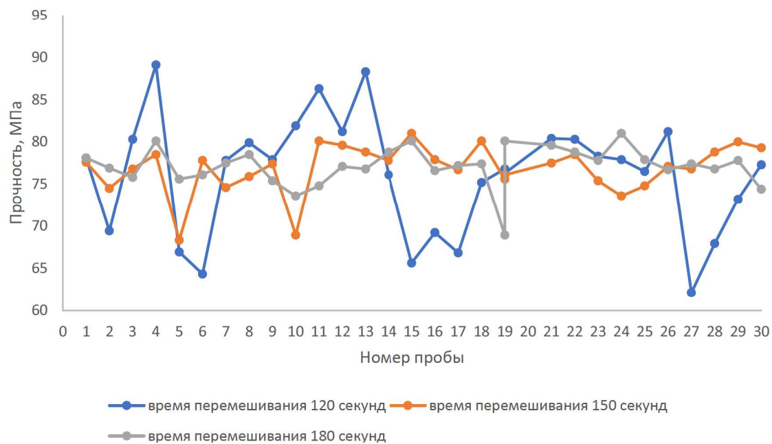
Рис. 5. Изменение прочности бетона самоуплотняющейся бетонной смеси бетонной смеси БСТ В60РК1 F 200 W12
