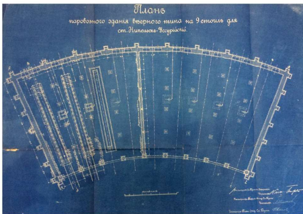
Рис. 6. План паровозного здания веерного типа на 9 стойл для ст. Никольск-Уссурийский, проект (автор: инженер Н. А. Казы-Гирей) [15]
