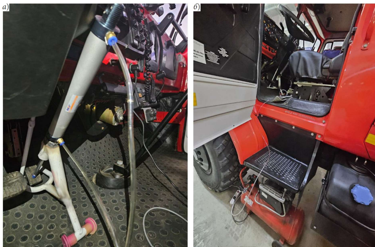
Рис. 2. Размещение устройства изменения скоростного режима двигателя: а — вид в кабине; б — вид около кабины пожарного автомобиля
