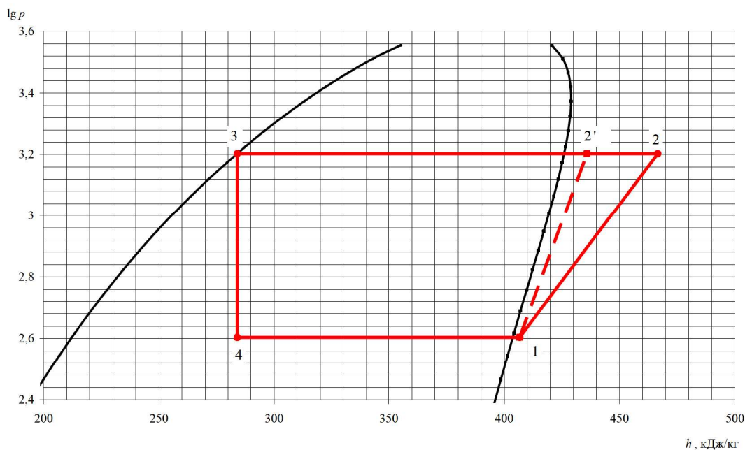
Рис. 7. Изменение состояния хладагента в цикле одноступенчатого теплового насоса
