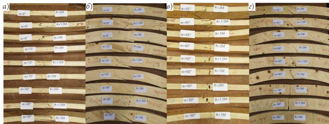
Рис. 5. Влияние угла наклона на характер разрушения образцов: а, в — вид снизу; б, г — вид разрушения на боковой поверхности образца
