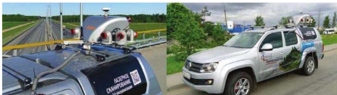
Рис. 3. Общий вид передвижного сканирующего комплекса на базе легковых автомобилей
