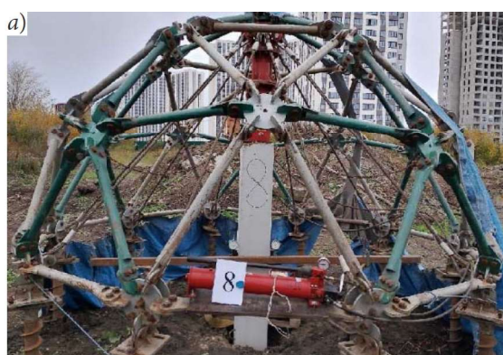
Рис. 4. Натурные испытания грунтов сваями: а — общий вид установки; б — верификация свайных интерфейсов
