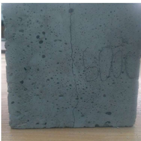
Рис. 6. Неармированный образец после выдержки при 600 °С
