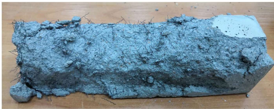
Рис. 8. Поверхность сталефибробетонного образца после разрушения взрывного характера
