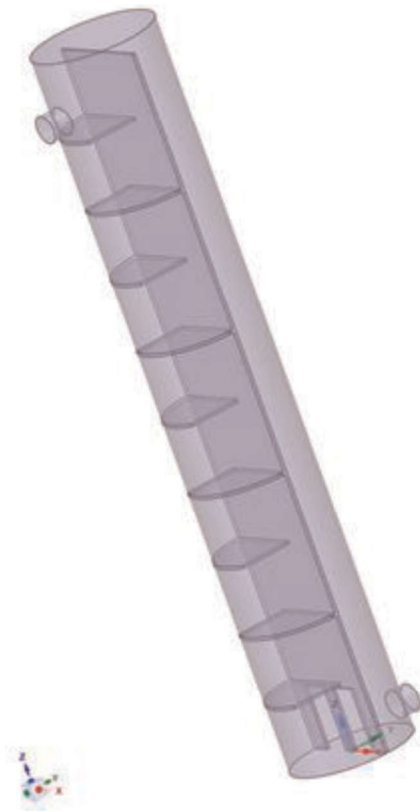
Рис. 1. Геометрия расчетной области модели вертикальной перепадной шахты
