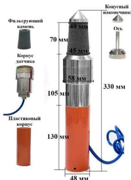
Рис. 3. Конструкция струнного датчика порового давления (ДПД)
