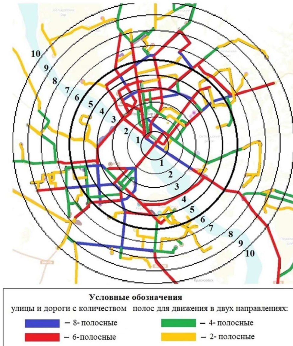
Рис. 2. Пример построения карты магистральной сети города с указанием количества полос для движения транспорта и делением его на отдельные километровые зоны
