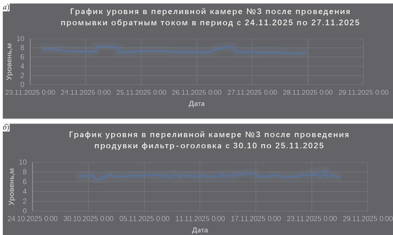
Рис. 7. Графики изменения уровня воды в переливной камере № 3 в осенний период: а — после проведения промывки обратным током; б — после проведения продувки
