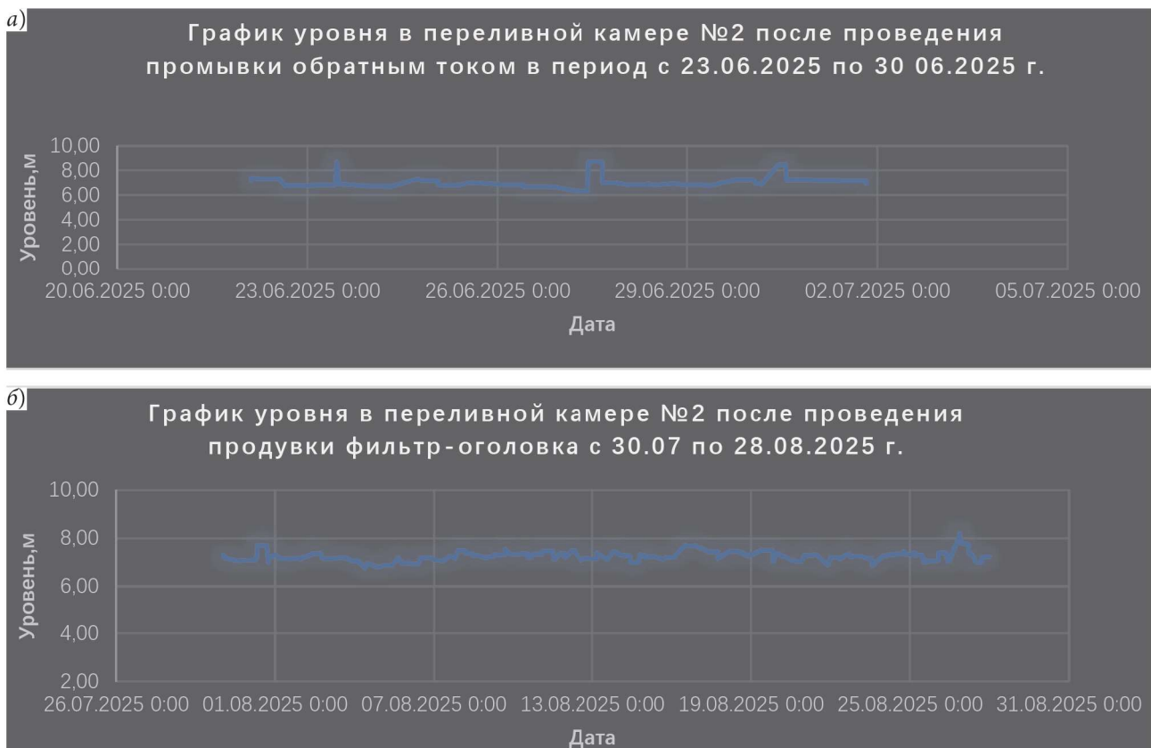
Рис. 6. Графики изменения уровня воды в переливной камере № 2 в летний период: а — после проведения промывки обратным током; б — после проведения продувки
