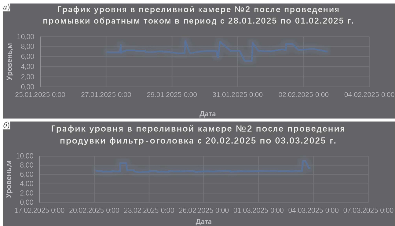
Рис. 5. Графики изменения уровня воды в переливной камере № 2 в зимний период: а — после проведения промывки обратным током; б — после проведения продувки
