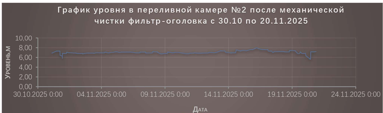
Рис. 8. График изменения уровня воды после механической чистки фильтр-оголовка в осенний период
