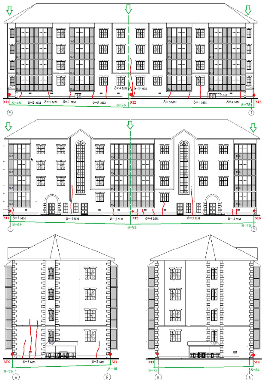
Рис. 3. Схема деформации здания: карта дефектов — трещины в кирпичной кладке наружных стен с указанием раскрытия трещин по состоянию на декабрь 2025 г; красным маркером показано расположение осадочных марок на фасаде дома; зеленым маркером — деформации осадочных марок
