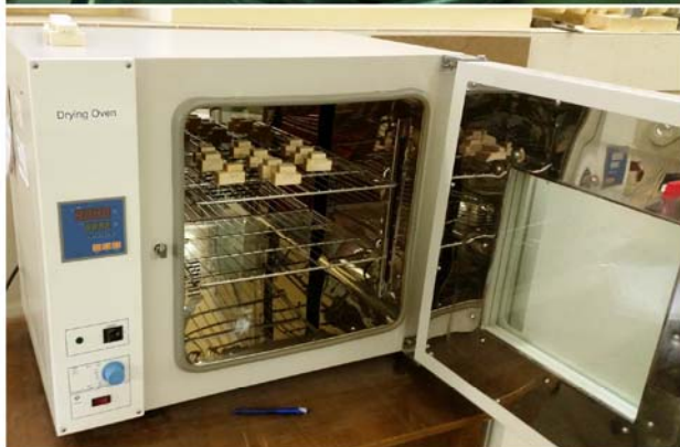
Рис. 2. Вымачивание и высушивание образцов
