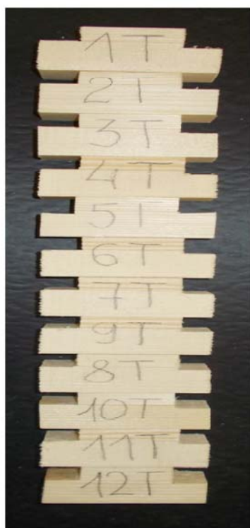
Рис. 7. Образцы для испытания на теплостойкость
