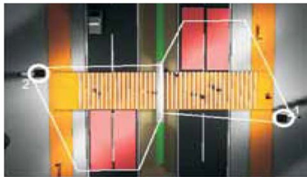
Рис. 8. Применение цветного покрытия автомобильной дороги и освещения в зоне пешеходного перехода
