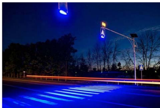
Рис. 4. Использование синей подсветки в зоне нерегулируемого пешеходного перехода
