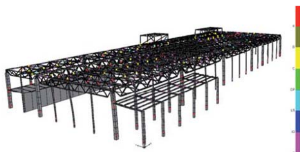
Рис. 4. Модель каркаса S_{tip} , соответствующая уровню повреждений E
