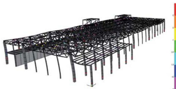
Рис. 3. Модель каркаса S_{tip} , соответствующая уровню повреждений LS
