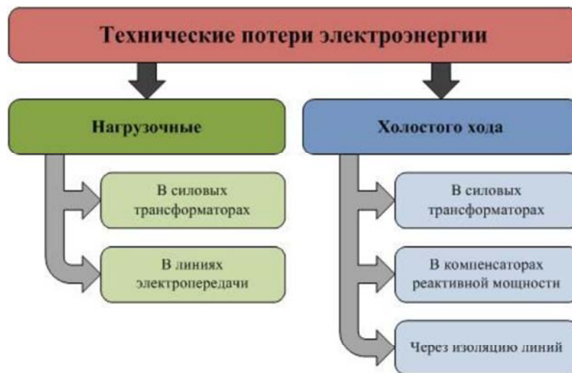
Рис. 3. Обобщенная структура технических потерь электроэнергии
