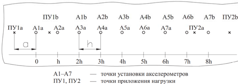
Рис. 3. Схема измерений скорости изгибных волн в конструкции
