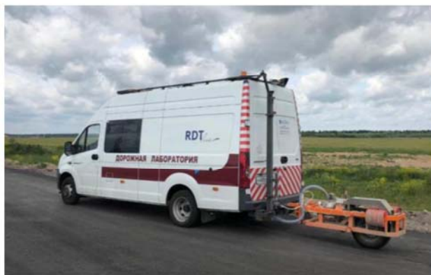
Рис. 4. Дорожно-измерительный комплекс КП-514 RDT
