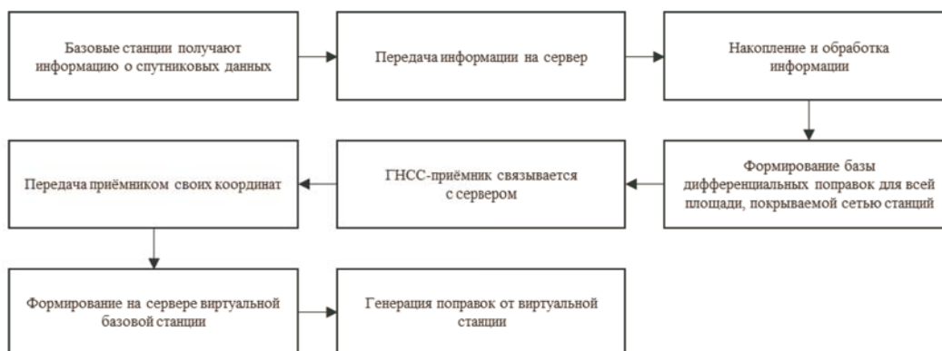
Рис. 10. Алгоритм работы виртуальной базовой станции
