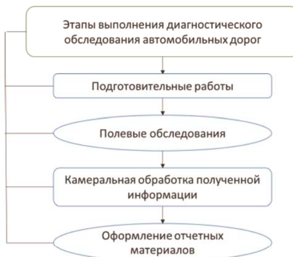
Рис. 1. Система проведения диагностического обследования дорог
