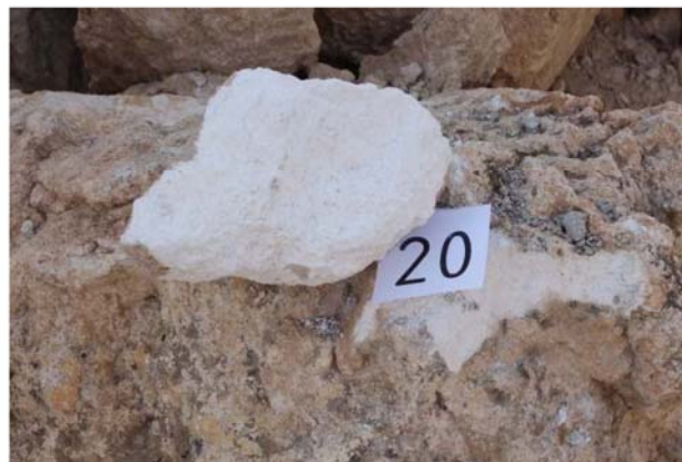
Рис. 4. Образец мела, использованного при строительстве Арки
