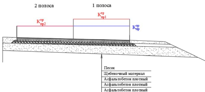
Рис. 2. Распределение прочностных показателей разнопрочной дорожной конструкции по ширине проезжей части
