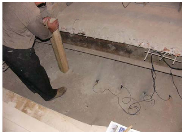
Рис. 1. Возбуждение изгибных волн в конструкции с использованием тампера
