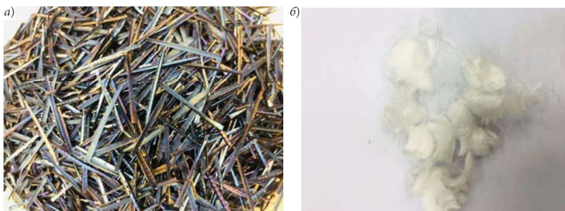
Рис. 1. Материалы для производства дисперсно-полиармированных бетонов: а — фибра стальная фрезерная; б — микрофибра синтетическая
