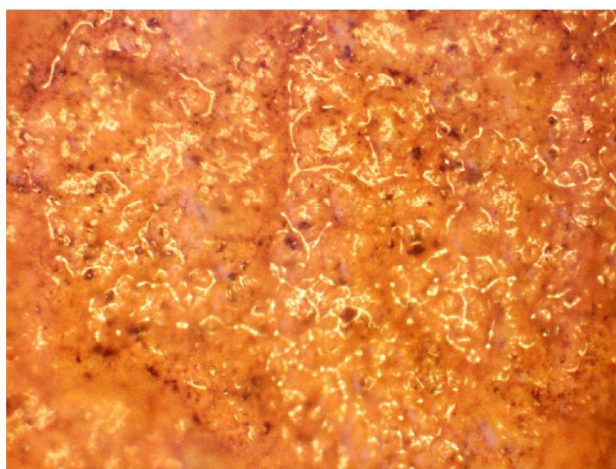
Рис. 5. Съемка образца коррозионных отложений под микроскопом с увеличением в 1000 раз
