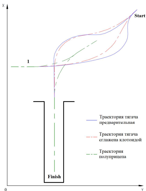
Рис. 4. Моделирование траектории движения автопоезда при выполнении вертикальной парковки
