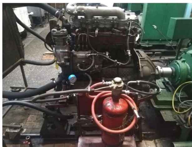
Рис. 1. Натурная модель альтернативной системы питания на двигателе ММЗ Д-245
