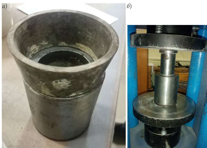
Рис. 2. Формовка методом полусухого прессования: а — пресс-форма с растворной смесью; б — процесс формования образца
