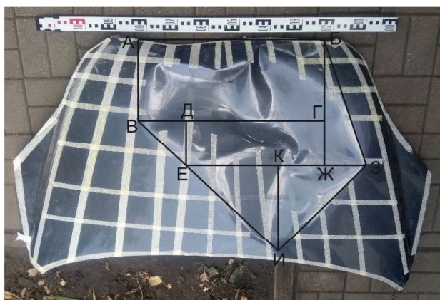
Рис. 5. Вид и размеры поврежденной части капота
