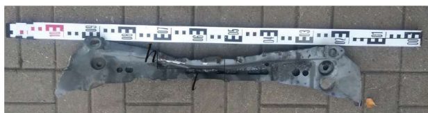
Рис. 4. Вид и размеры поврежденной части нижней переборки
