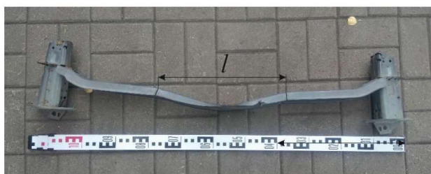
Рис. 2. Вид и размеры поврежденной части усилителя бампера
