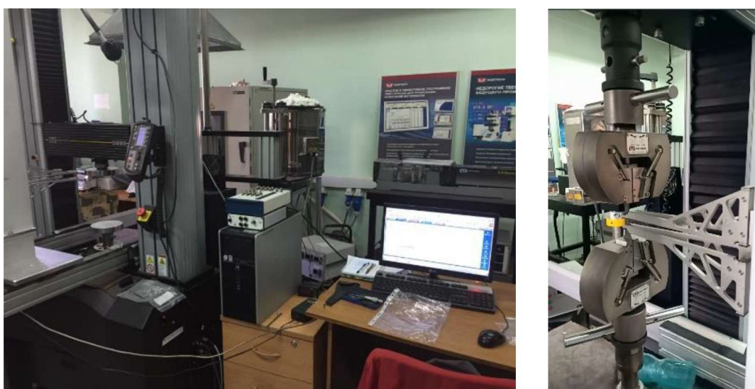
Рис. 7. Испытания образцов материала, изъятых с деформированных деталей автомобиля
